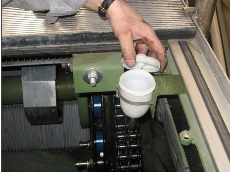
Resim 3.22: Periyodik bakımlarda yağ seviyesi tamamlanır
