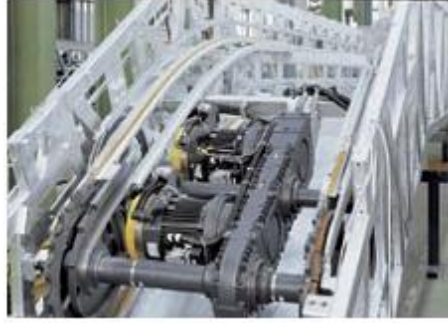
Resim 3.2: Tahrik motorunun gücünü direkt basamak zincirine veren farklı bir tahrik sistemi
