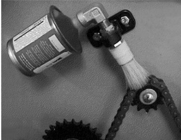
Resim 3.19: Ana tahrik zinciri için hem yağlama hem de artıkları temizleme metotlarından biri
